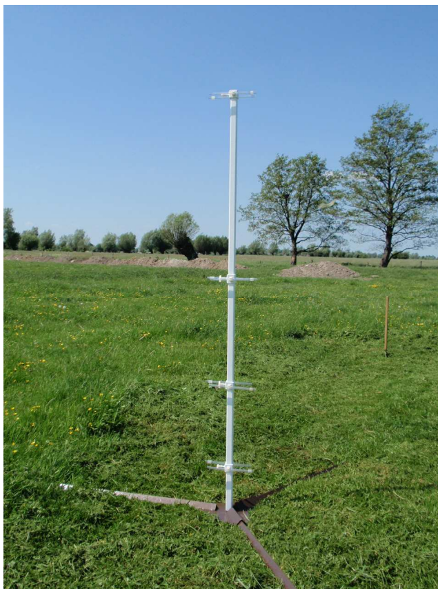
Fot. 7. Maszt z zestawem próbników strumieniowych przygotowany do pomiaru.
