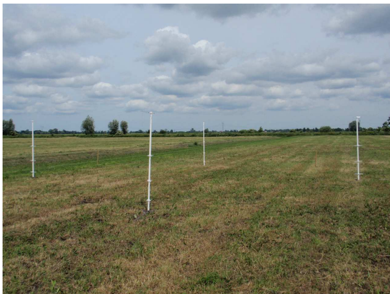
Fot. 5. Pomiar emisji amoniaku z łąki nawiezionej saletrą amonową – gospodarstwo C, poletko pierwsze
