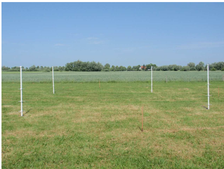
Fot. 3. Pomiar emisji amoniaku z łąki nawiezionej mocznikiem – gospodarstwo B, poletko pierwsze
