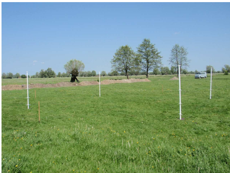
Fot. 1. Pomiar emisji amoniaku z łąki nawiezionej saletrą amonową – gospodarstwo A, poletko pierwsze.
