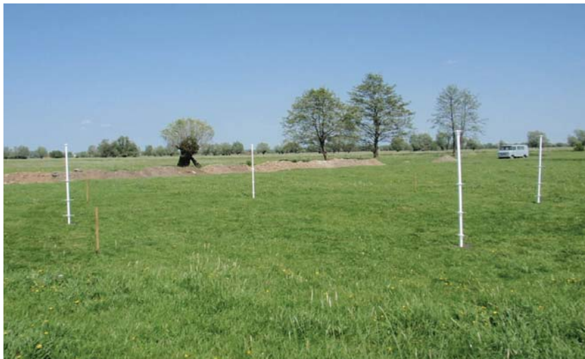
Pomiar emisji amoniaku metodą mikrometeorologicznej dozymetrii pasywnej.
